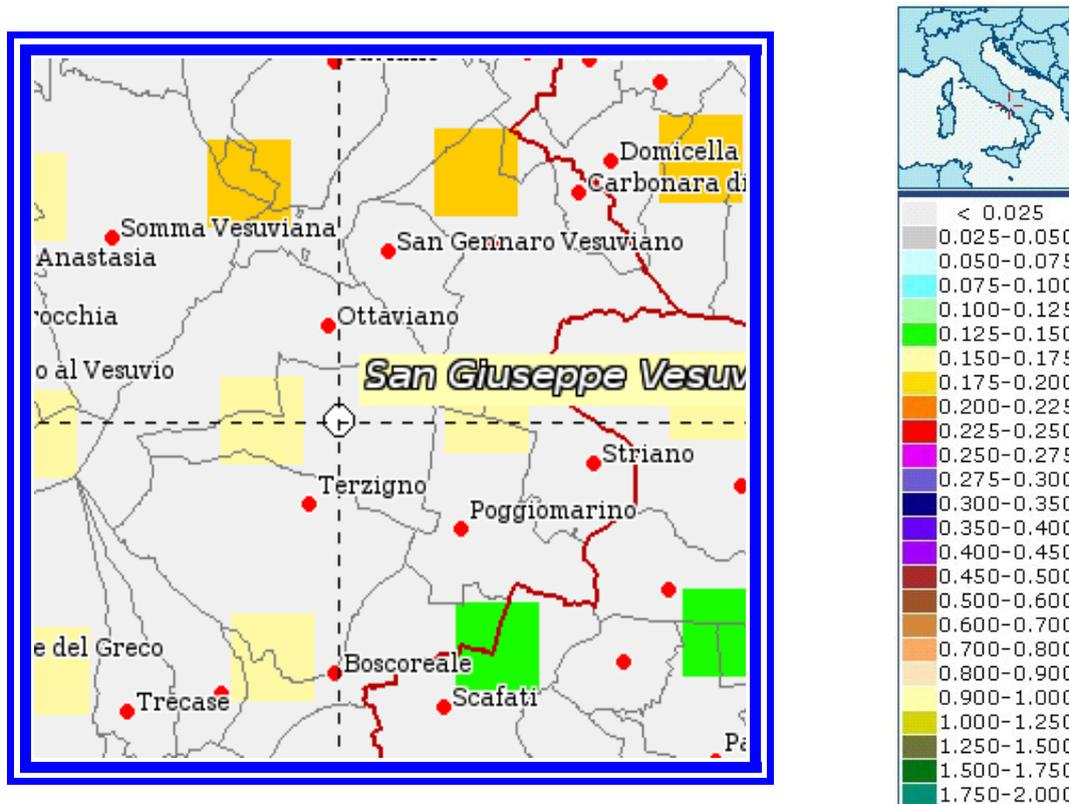
Fig.7: Mappa di pericolosità sismica redatta a cura dell'INGV secondo le Nuove Norme Tecniche per le Costruzioni (D.M. 14/01/2008) - Punti della griglia riferiti a: parametro dello scuotimento  $a_g$ ; probabilità in 50 anni 10%; percentile 50.
