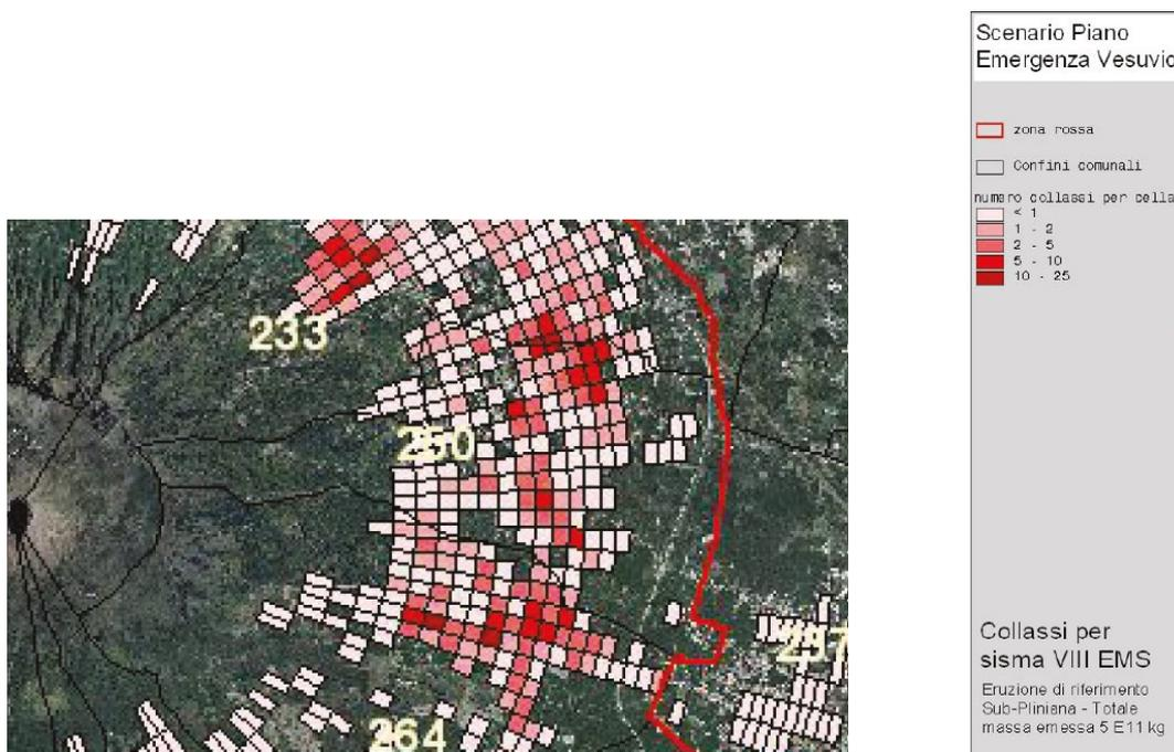
Figura 13 - Scenario di Danno (crolli totali D5 e parziali D4) per un evento sismico di Intensità pari al VIII grado EMS con epicentro nel cratere
