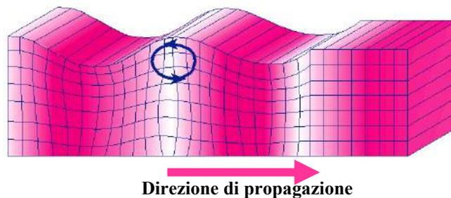
**Fig. 2 - Rappresentazione grafica della propagazione delle onde superficiali di Rayleigh caratterizzata dall'oscillazione polarizzata in un piano verticale e con movimento delle particelle retrogrado rispetto alla direzione di propagazione dell'onda.**
