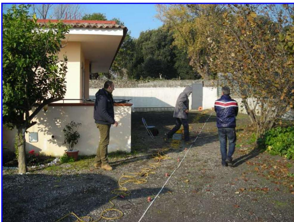
**Fig. 1 – Prospezione sismica MASW effettuata.**
